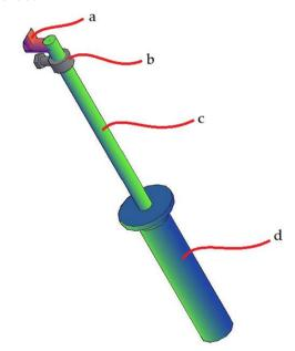
**Figure 4.** Seal remover: (a) lever, (d) adjusting bolt, (c) lever bar, and (d) handle
